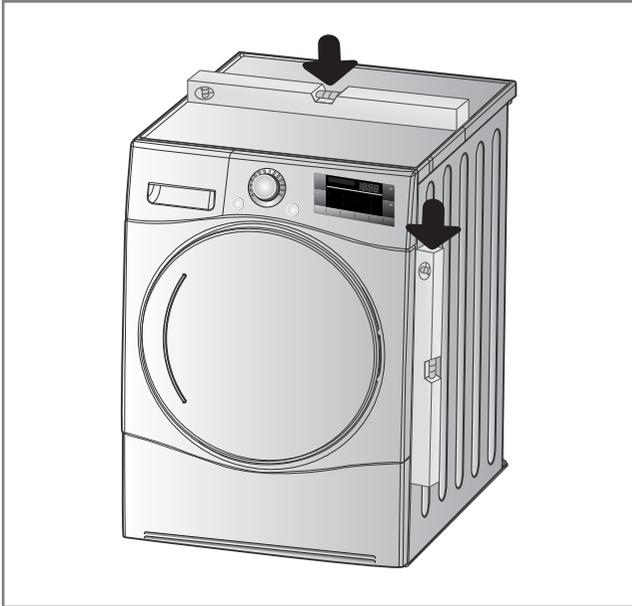
1. La mise à niveau du sèche-linge empêche les bruits et vibrations inutiles. Installez votre sèche-linge sur un sol stable et à niveau.
