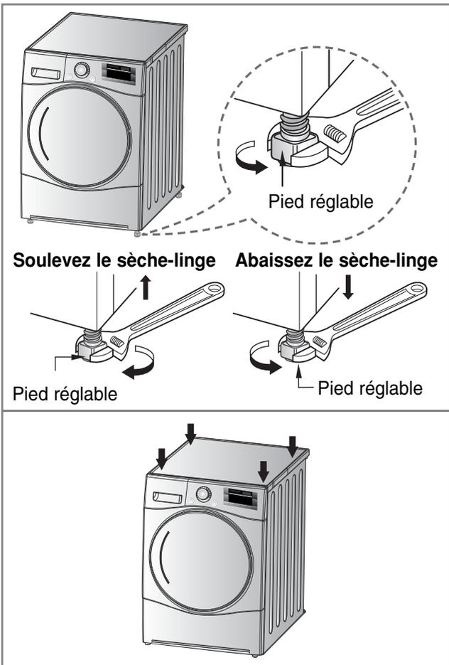
2. Si le sèche-linge n'est pas correctement à niveau, réglez les pieds de mise à niveau à l'avant si nécessaire.
