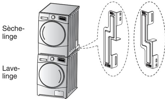
Ce sèche-linge peut uniquement être superposé sur un lave-linge LG. **NE TENTEZ PAS** de superposer ce sèche-linge sur un autre lave-linge, car cela pourrait provoquer des dommages, des blessures ou des dégâts matériels.
