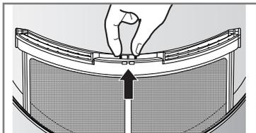
3. Nettoyez le filtre en utilisant un aspirateur ou en le rinçant sous le robinet Séchez-le.
